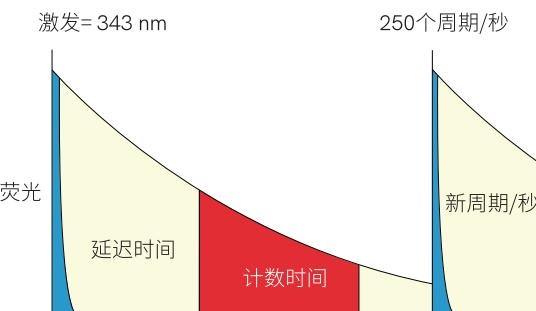
在 TRF 中，体系激发后，延迟一定时间，至背景消失，才对待测信号进行收集检测。（蓝色：激光激发脉冲；黄色：镧系元素的荧光信号；红色：检测期。）
