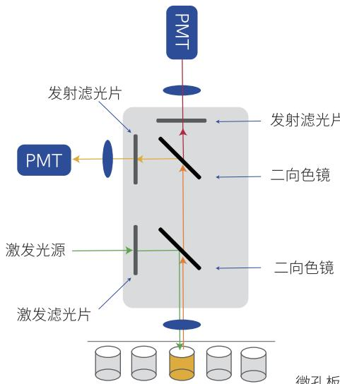
双探测器设计允许同时检测 FRET、BRET、TR-FRET 或 FP 的两个信号值，以实现高速度和极佳信噪比
